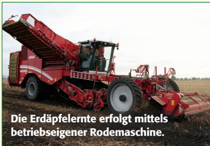
Die Erdäpfelernte erfolgt mittels betriebseigener Rodemaschine.
